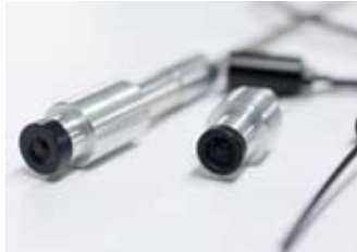
0.5ミリのイメージファイバー。先端に特殊なレンズが付いていて、どんなに曲げても画像が見える
